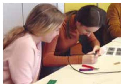
Nun ging es um den Bau eines Mini-Synthesizers, mit dem man die verrücktesten Geräusche erzeugen kann. Wir lernten, wie ein Synthesizer funktioniert: wie man einen Klang beschreiben kann, wie ein Ton dargestellt, erzeugt und manipuliert werden kann. Mit nur zehn Bauteilen haben wir die Klänge eines Ataris reproduziert. Wir haben löten gelernt und unseren eigenen Synthesizer gebaut, den wir hinterher auch mit nach Hause nehmen konnten.
